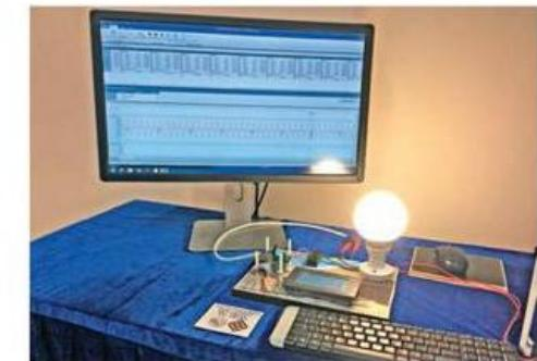
▲首個能實時回應頻率變化的智慧型電器負載控制器示意圖
